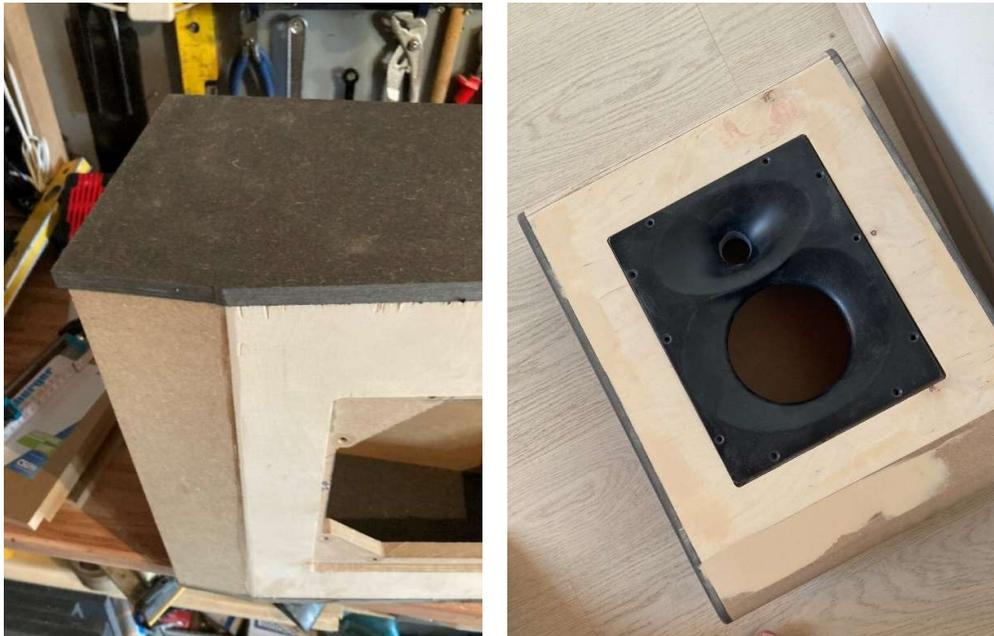
Nach Trocknung fräse ich diese mittels Bündigfräser bei. Das BR Rohr säge ich innen mit angemessener Distanz zum Innenrand grob aus und fräse auch hier mittels Bündigfräser bei.
