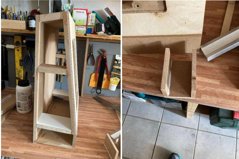
Wer möchte kann in die beiden 6cm breiten Streben (auf dem Bild die Weißen) mittels Forstner Bohrer noch Löcher bohren, um den Durchlass im Gehäuse zu verbessern.
