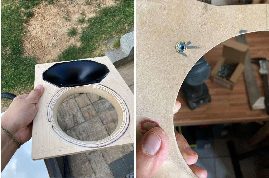
Befestigt wird der Mitteltöner mittels Rampa Muffen M4 die ich in das Holz von hinten reinschraube. Einfach dazu den MT passend auf die Öffnung legen, vorbohren, nachbohren und die Schrauben reindreihen. Es ist darauf zu achten, dass man nicht durchbohrt.
