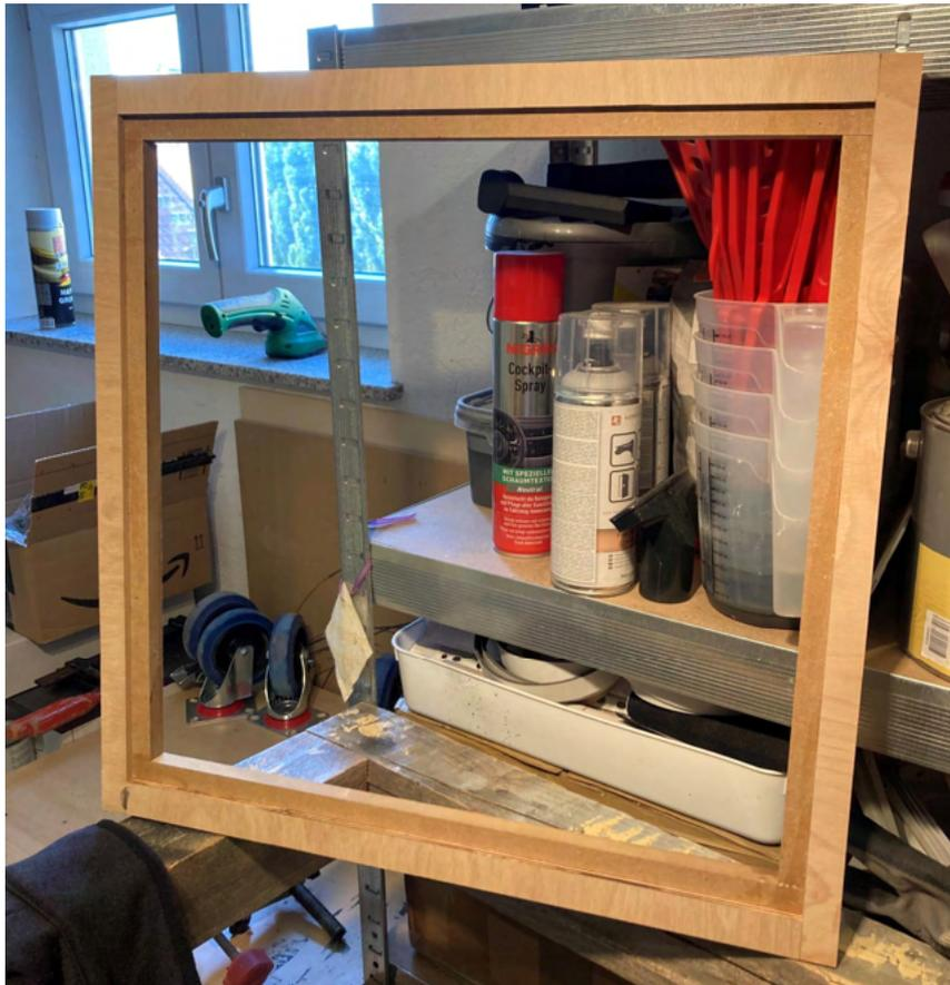
Die obere Lage habe ich etwas größer gesägt und dann nach dem Verleimen mit der unteren Lage des Rahmens bündig gefräst, um eine saubere Kante zu gewährleisten.
