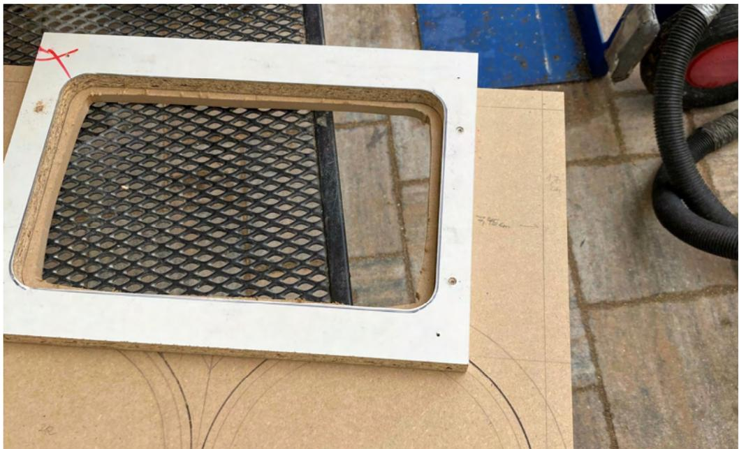
Anschließend mit dem Bündigfräser bündig fräsen.
