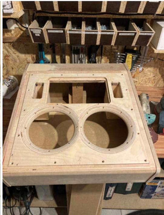
Jetzt müssen noch die Bass Reflexbretter verleimt werden und man muß den Speakon Anschluss „frei legen“. Dies macht man wiederum mit einem Bündigfräser und bohrt mit einem 24mm Forstnerbohrer.
