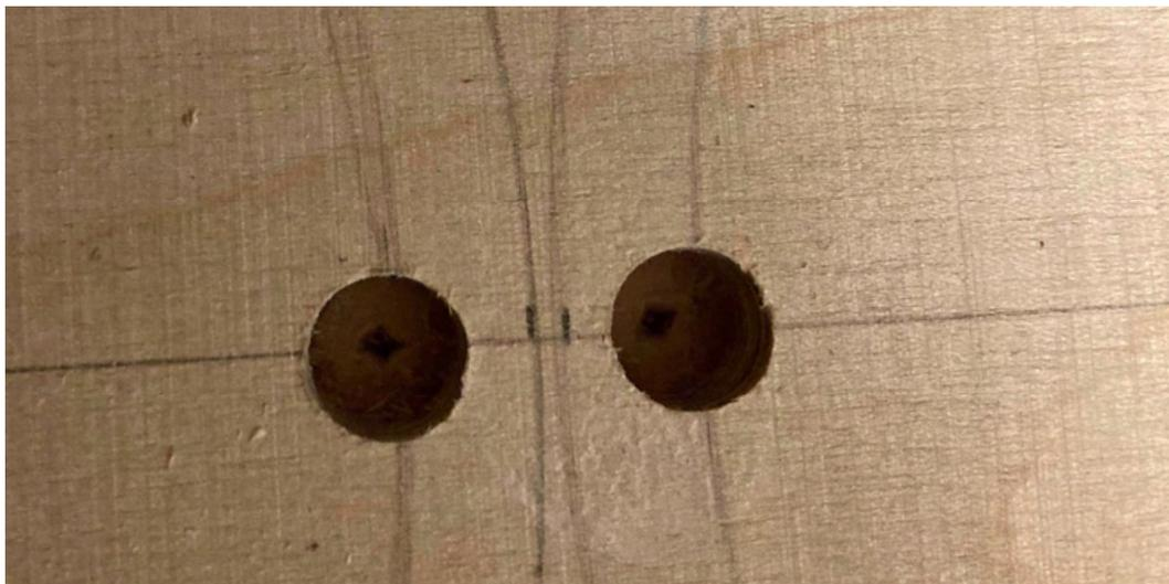
In dieses Loch dann ebenfalls mit einem Holzbohrer mit Spitze entsprechend dem Schraubendurchmesser durchbohren (M5).
