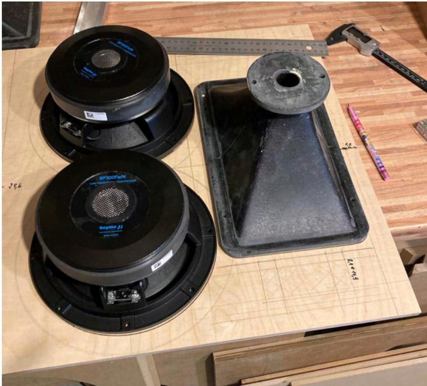
Dazu sollte man alle Teile, d.h. Tiefmitteltöner und das Horn auf der Front Platte (8mm) positionieren und entsprechend anzeichnen.
