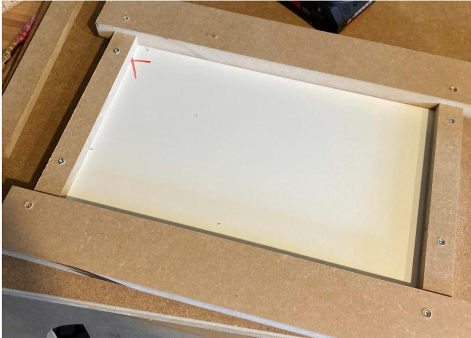
Im Nächsten Schritt sind die Ecken dran. Dazu nimmt man einen dem Radius des Jig Routers entsprechenden Forstnerbohrer (auf Radius vs. Durchmesser achten!)
