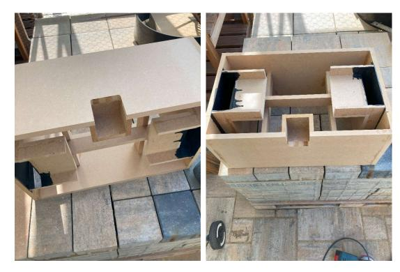
Am Ende verklebt man die Front und die Rückseite. Die BR Ports sowie der Anschluss hinten können dann auch mit dem Bündigfräser bearbeitet werden. Hierzu empfiehlt es sich mit der Sticksäge grob vorzusägen.
