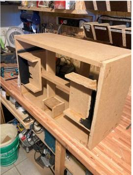
Anschließend wird es mit dem Bündigfräser passend gefräst.
