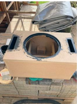
Die Dämmung sollte am Ende wie folgt verteilt werden
