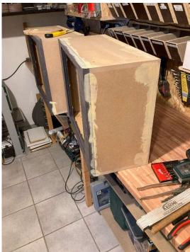
Das Mitteltongehäuse an sich wird auf 6 Brettern aufgebaut. Die Rückseite wird dabei nur drauf geschraubt
