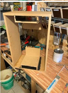
Im nächsten Schritt sind die Verstrebungen an der Reihe. Eine Längsstrebe und 2 Streben von oben nach unten sind ausreichend.
