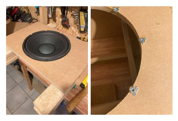
Im nächsten Schritt baut man die Bassreflexkanäle und schwärzt diese da man später schlecht hinkommt. Anschließend klebt man die Seitenteile zusammen und klebt die BR Kanäle ein. Auch hier die Seitenteile vorher schwärzen an der Stelle des BR Kanals.
